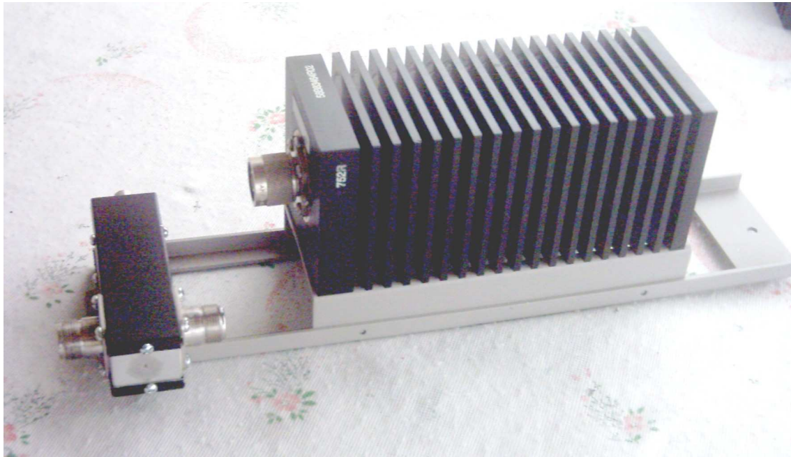
Zdjęcie 2. Obciążenie i tłumik 20dB do pomiaru mocy nadajnika.
